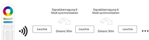
Jeder einzelne Strahler erweitert die Reichweite untereinander, dabei funktioniert jeder Strahler als Repeater und reicht Steuersignale weiter.
