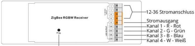
Programmtaste: kurzes drücken zum ein- / ausschalten, gedrückt halten zur Steuerung der Lichtintensität
