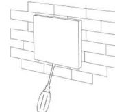
Greifen Sie einen Schraubendreher zwischen das Panel und die Basis und drücken Sie den Schraubendreher nach oben, dann können Sie das Panel abnehmen
